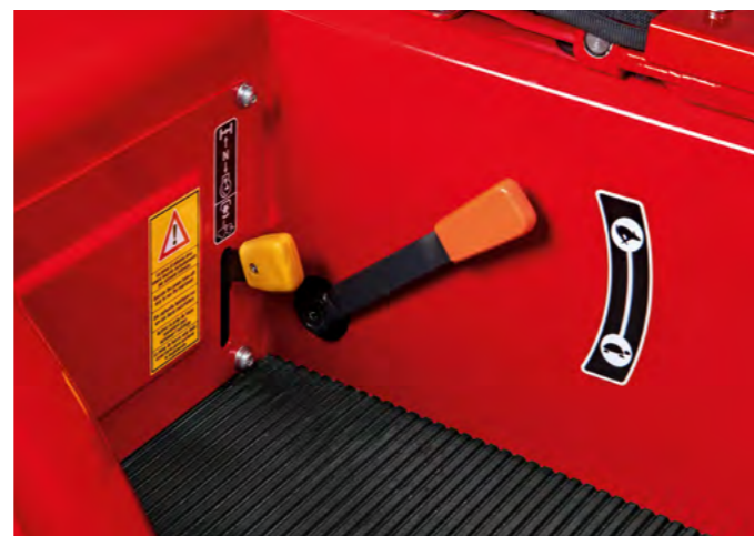
SÉLECTEUR MÉCANIQUE sélecteur mécanique à 2 gammes (travail et déplacements).
