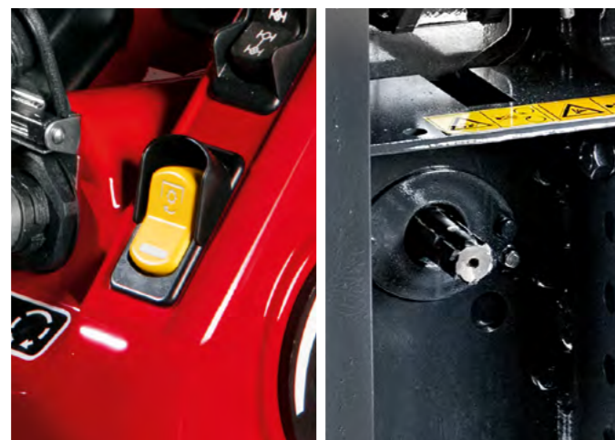
PDF à deux vitesses : 540/540E tr/min (de série) avec enclenchement électro-hydraulique progressif ; 540/1000 tr/min* proportionnelle à la vitesse de BV. L'arbre de Pdf, de type ASAE1 3/8, est unique pour toutes les vitesses.
